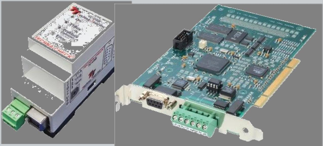
使用USB模块或者PCI卡的刀具监控系统与基于Windows的CNC控制器或者一台独立的电脑相连。联网状态下，一个USB模块或者
