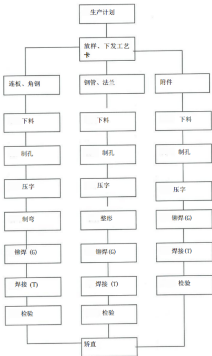
图 2.12 变电站构、支架工艺流程图
