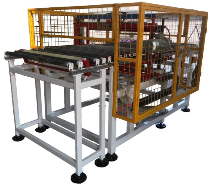
该同步切割机采用最新技术，通过伺服电机等测定和反馈真空挤压成型机输出的坯板长度及速度参数，驱动和控制切割装置同步动作，将连续输送的坯板切割成所需要的陶板产品尺寸。其独特设计的同步机理及切割方式，不仅使切割过程中无尾料产生，且滚刀式地切入切割精度高、质量好，同时切口光滑、自动倒角并无人为误差，从而保证了高效生产及成型质量。是陶板等大规格产品生产的最佳选择。
