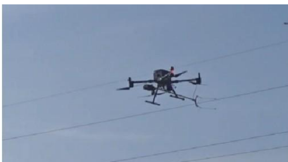
机载绝缘子检测装置升空
