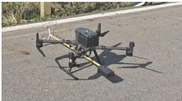
机载绝缘子检测装置
