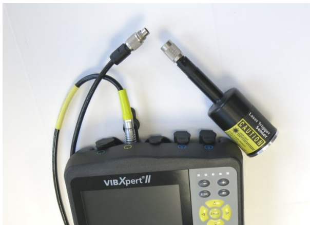
激光触发器/RPM 传感器 VIB 6.631 的传感器电缆，已连接到 VIBXPERT II
