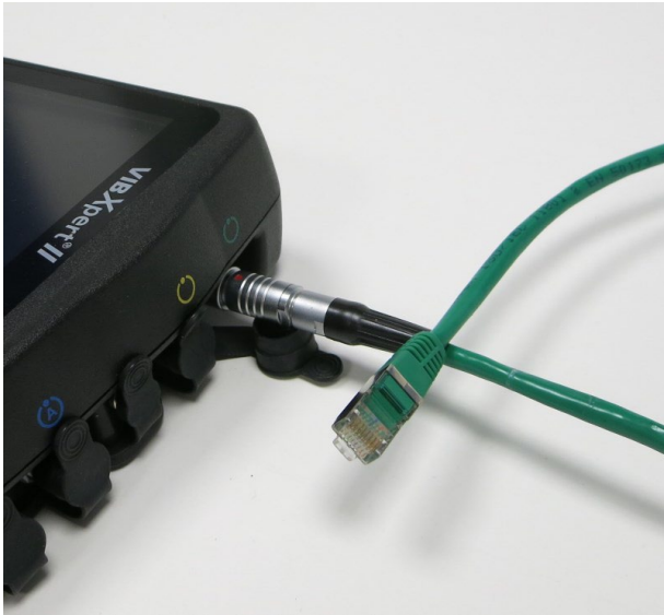
已连接到 VIBXPERT II 的以太网电缆
