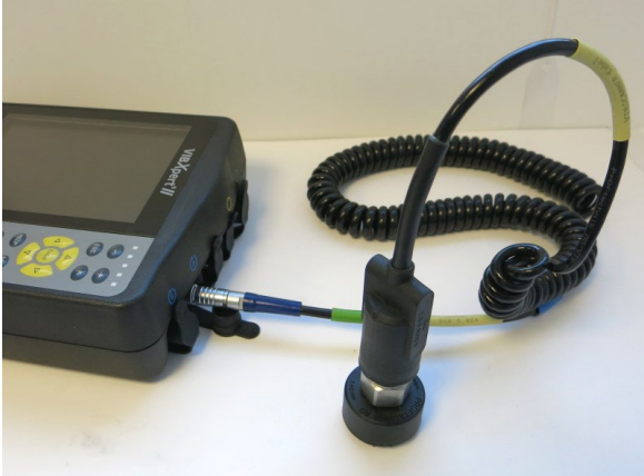
传感器 VIB 6.142，已通过特殊连接电缆 VIB 5.436 连接到 VIBXPERT II
