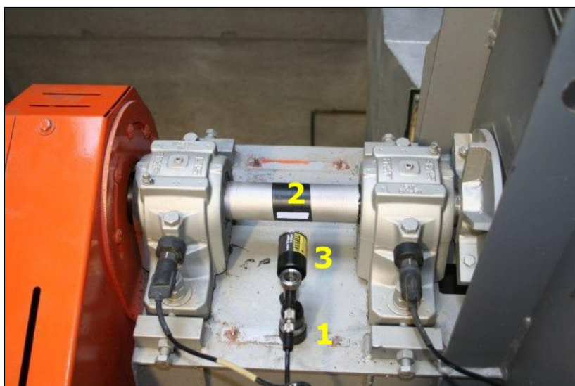
测量 RPM: 支架(1)、位于轴上的反光胶带(2)和 RPM 传感器(3)。
