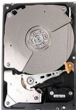
图 2.6 硬盘内部结构
