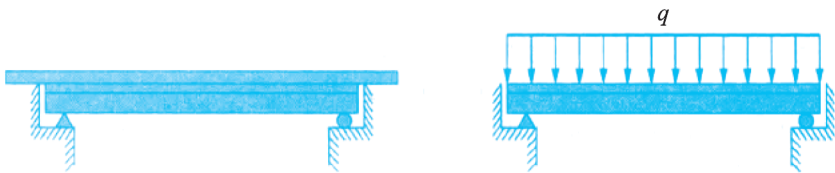
图 1-3 沿梁的轴线分布的线荷载
