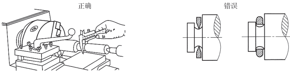
图2-7 测量沟槽时正确与错误的位置
