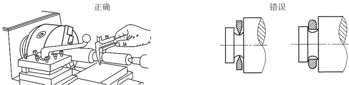
图2-7 测量沟槽时正确与错误的位置
