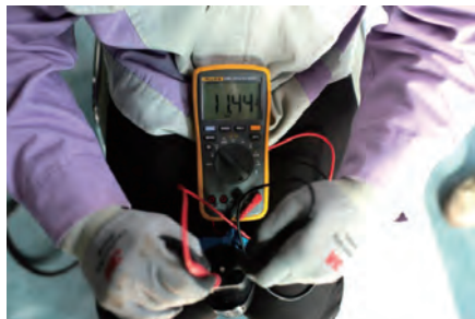
图 2-39 充电枪 CP 电压检测
