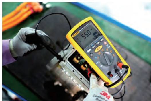
图 2-83 发电机的 V 相绝缘电阻值检测
