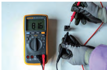
图 3-57 灯光继电器线圈电阻测量
