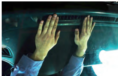
图 4-52 用手感觉除霜出风口的气流
