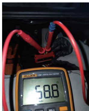
图 2-68 检测 CAN 线电阻值
