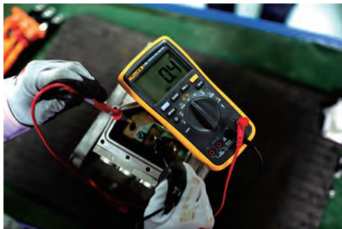
图 2-78 发电机 V-W 相电阻检测
