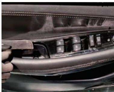
图 4-83 撬下车窗玻璃开关盖板
