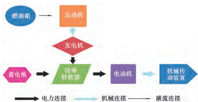
图 2-20 减速/制动工况下的能量流动
