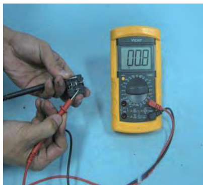
图 3-58 灯光继电器常闭触点检测示意图
