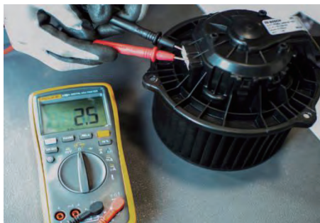
图 4-57 用万用表测量鼓风机马达
