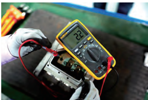
图 2-77 发电机 U-W 相电阻检测
