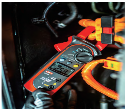
图 2-33 高压电气控制总成输入电压检测
