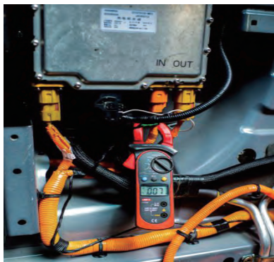
图 2-41 车载充电机高压输入交流电检测
