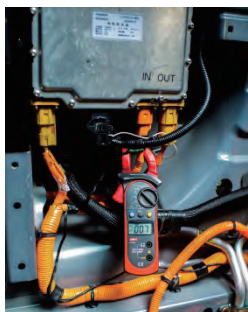
图 2-11 车载充电机高压输入交流电检测
