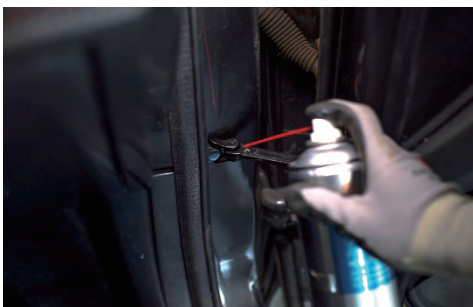
图 4-80 用清洁润滑剂喷到各车门铰链处
