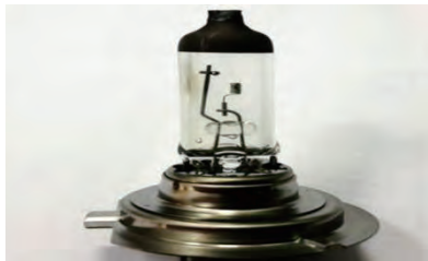
图 3-53 灯光电路灯丝熔断
