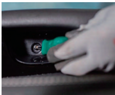
图 4-85 拧下车门饰板的固定螺钉
