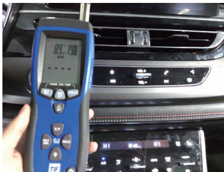
图 4-8 鼓风机四挡转速在 1 500 转时
