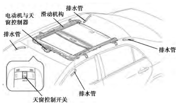
图 4-100 汽车天窗结构
