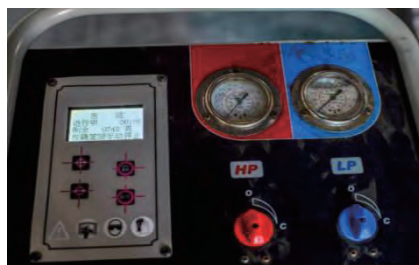
图 4-37 回收制冷剂的重量
