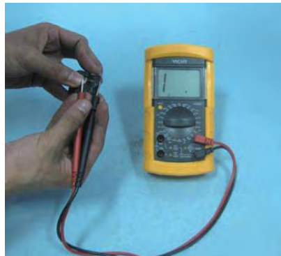
图 3-58 灯光继电器常闭触点检测示意图
