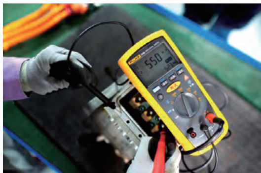
图 2-82 发电机的 U 相绝缘电阻值检测
