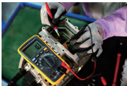
图 2-59 启动机 U-V 相电阻
