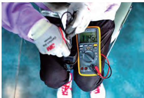
图 2-10 充电枪 CP 对 PE 电压
