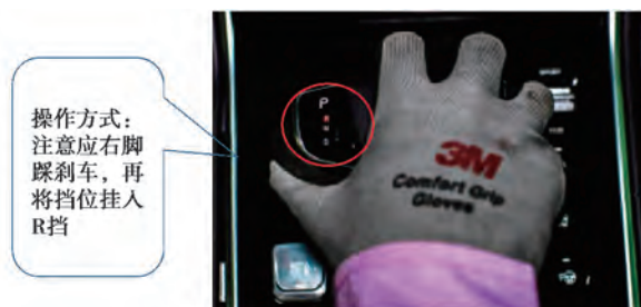
(b) 换挡杆挂入倒挡, 点亮后方倒车灯
