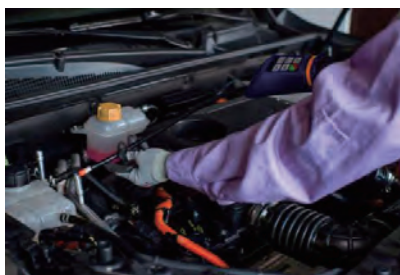
图 4-14 电子检漏仪检漏
