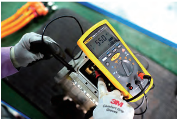
图 2-84 发电机的 W 相绝缘电阻值检测
