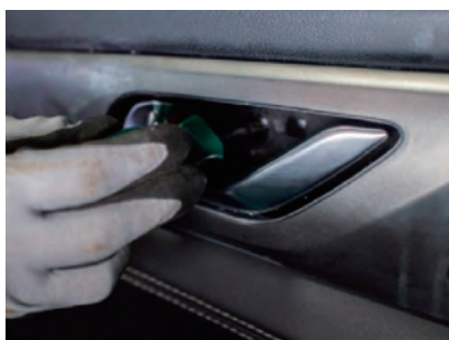
图 4-86 撬下车门内拉手固定螺钉的装饰盖板
