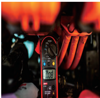
图 2-34 高压电器控制总成与驱动电机电流检测
