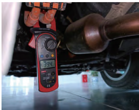
图 2-32 动力电池输出电压检测
