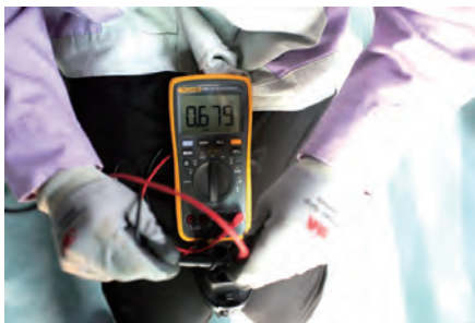
图 2-38 随车携带充电枪 CC 与 PE 电阻
