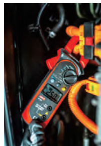
图 2-4 高压电器总成输入电压
