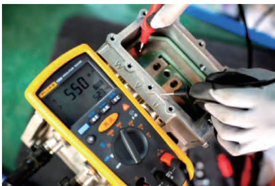
图 2-71 启动机的 W 相绝缘电阻值
