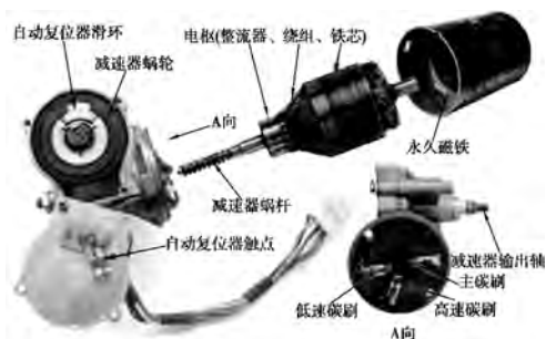
图 3-29 刮水器电动机组成
