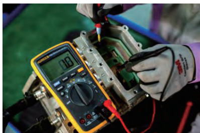
图 2-60 U-W 相电阻检测
