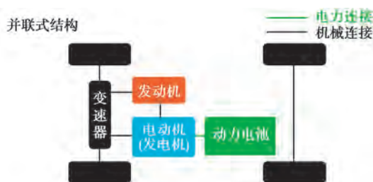
图 2-25 并联式混合动力电动汽车的结构示意图
