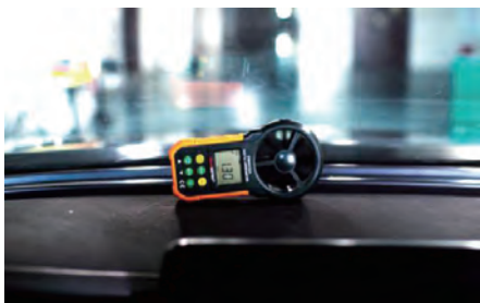
图 4-49 用风速计测量进风口气流
