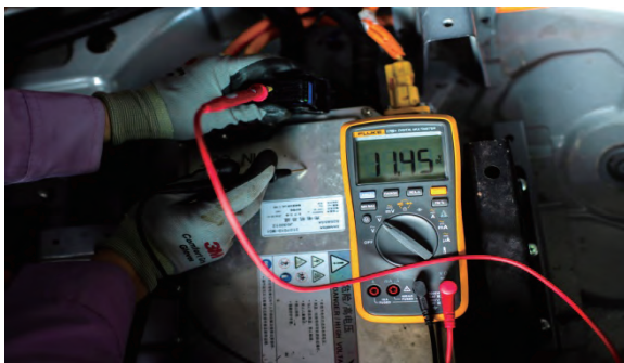
图 2-40 车载充电机低压插接头 CP
