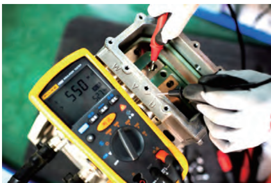
图 2-70 启动机的 V 相绝缘电阻
