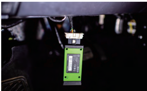
图 2-13 解码仪与诊断接口连接
