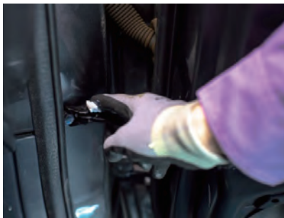
图 4-81 将专用润滑脂均匀涂抹在各车门铰链上
