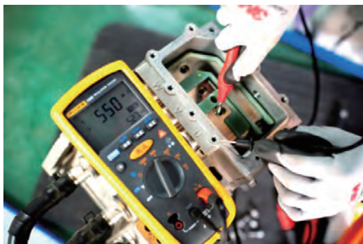
图 2-69 启动机的 U 相绝缘电阻值
