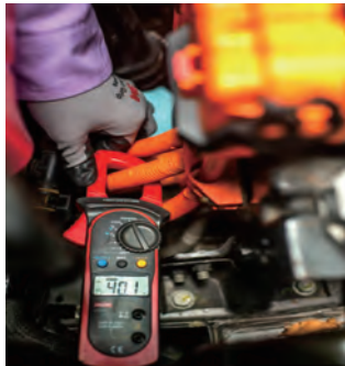
图 2-35 高压电器控制总成与发电机电流检测
