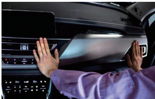
图 4-50 用手感觉中央出风口和侧通风口
