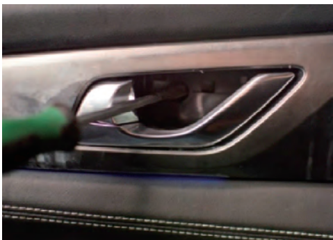
图 4-87 拧下车门内拉手固定螺钉
