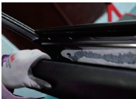
图 4-89 取下车门饰板,并断开车内拉手拉索
