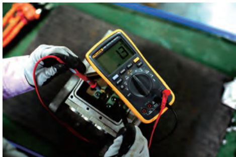
图 2-76 发电机 U-V 相电阻检测
