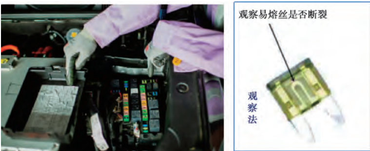
图 3-51 按照索引找到对应远光灯保险丝并检查外观
