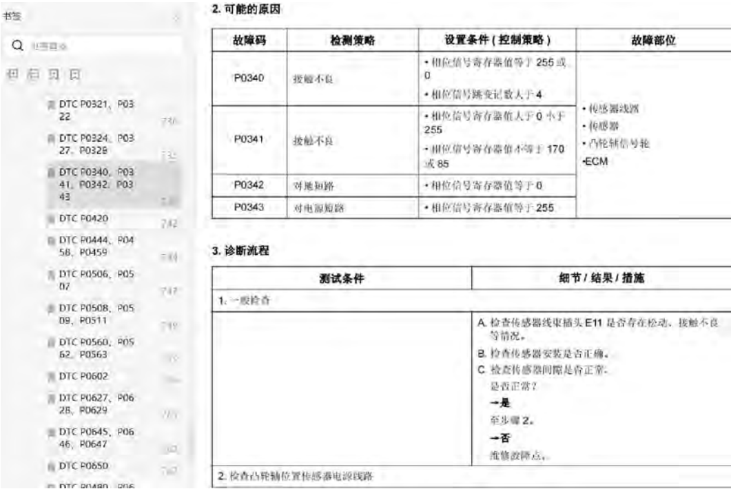
图 1-23 查询凸轮轴位置传感器的诊断流程
