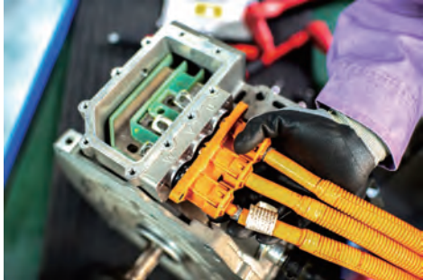
图 2-57 启动机的三相绕组高压线束拆卸
