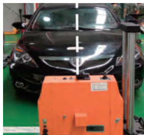
图 3-2 检测仪与被检汽车对准
