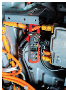
图 2-12 车载充电机输出的高压直流电检测
