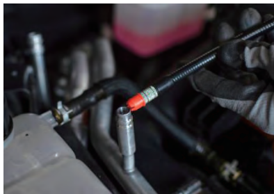
图 4-15 电子检漏仪检漏
