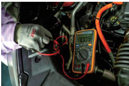
图 3-56 前照灯灯泡搭铁情况检测示意图
