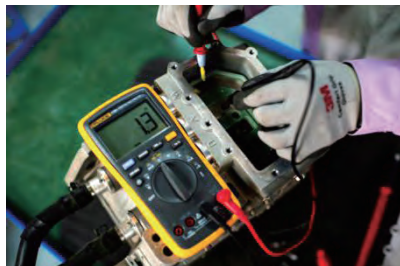
图 2-61 V-W 相电阻检测
