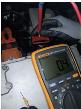
图 2-67 线束端子 19 对地电阻检测
