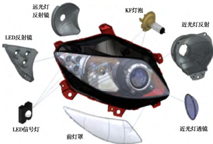
图 3-11 汽车前照灯结构
