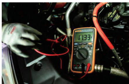
图 3-55 前照灯灯泡输出电压检测示意图
