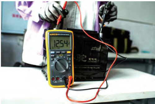
图 3-60 蓄电池电压检测示意图
