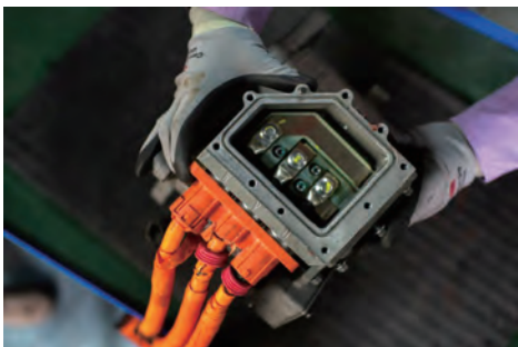
图 2-75 发电机三相绕组的连接图
