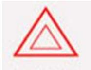
\_\_\_\_\_作用：又名双闪灯，车辆发生故障需要临时停车等紧急情况下使用，在能见度较低的恶劣天气也应打开双闪
