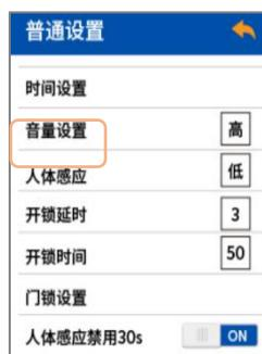
设定设备声音大小，同时设定前后驱动板声音大小，声音有静音、低、中、高 四档可调。
