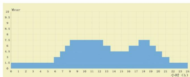
高压并联电容器柜按负荷变化自动投切示意图
