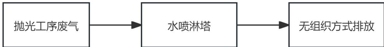
图 3-4 抛光工序废气处理工艺流程图
