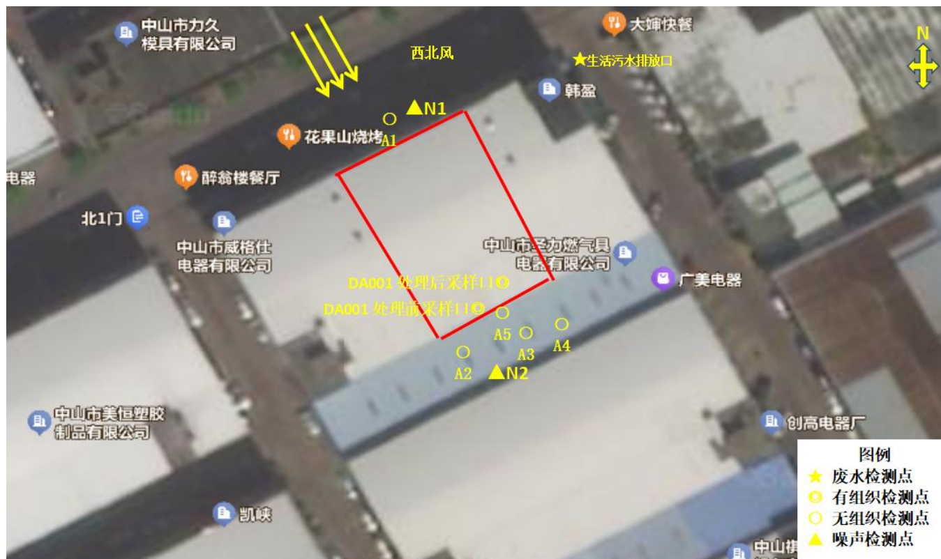
图 6-1 生活污水、有组织废气、无组织废气、噪声监测点位示意图
