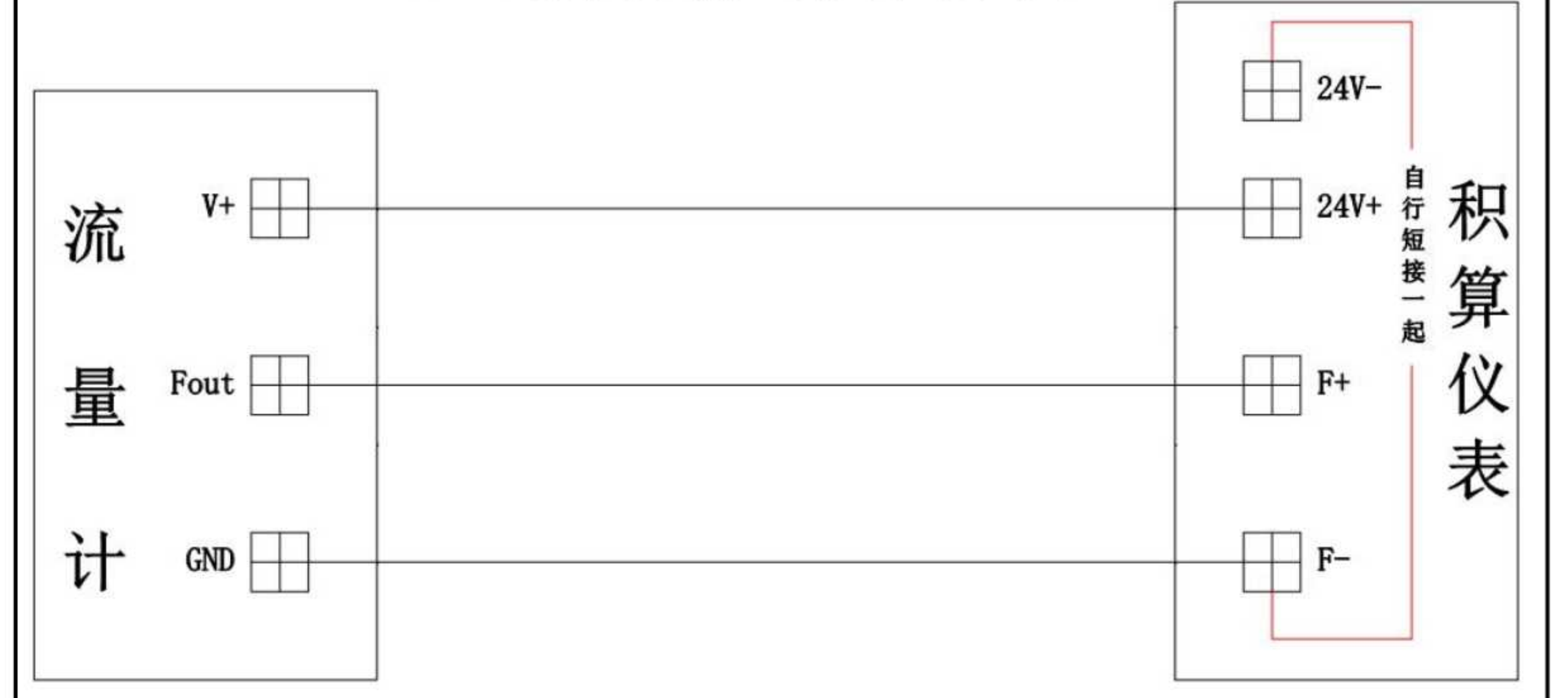
三线脉冲输出接积算仪
