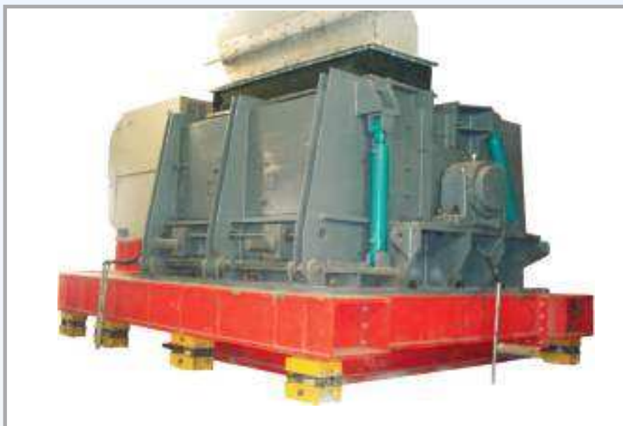
环锤式破碎机及减震平台
