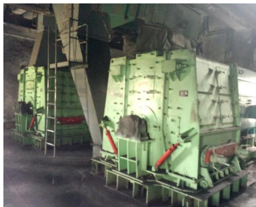
改造后的可逆锤式破碎机
