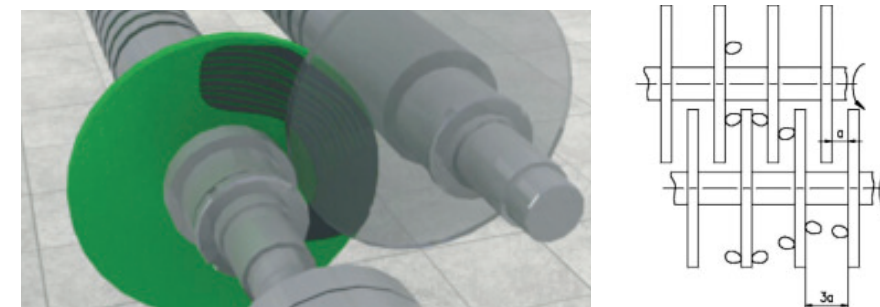
同向旋转的筛轴，筛片间“动态筛孔”、“手搓式”运动，自清理。
