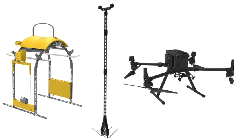
无人机挂载版绝缘子检测机器人
