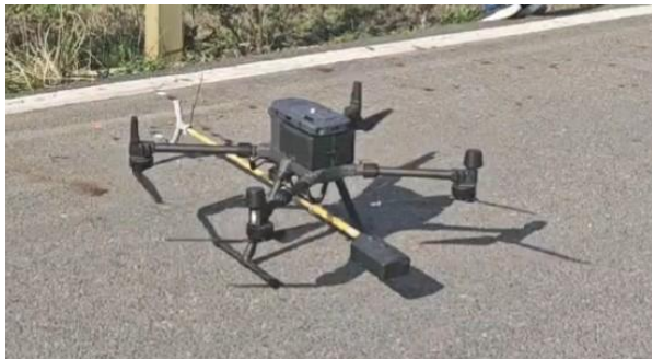
机载绝缘子检测装置
