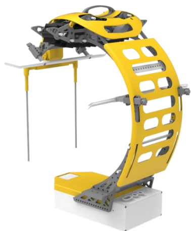
人工挂载版绝缘子检测机器人
