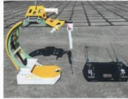
图3 ZH-ACHV 型绝缘子串检测机器人系统试品实拍
