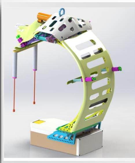
绝缘子检测机器人
